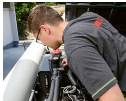
Eenvoudige visuele controle van alle oliepeilen.
