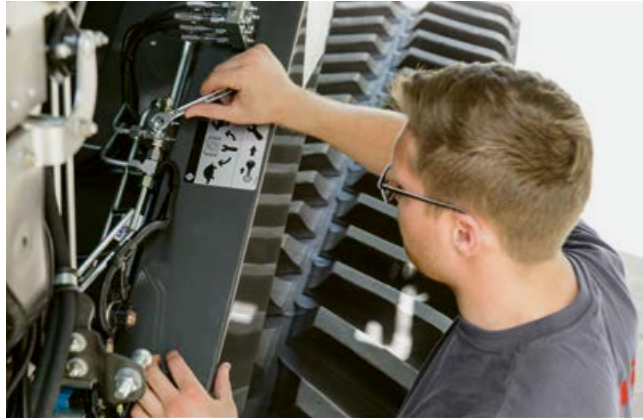
De twee toerentalbereiken van de reductietransmissie van de dorstrommel kunnen handmatig worden ingesteld met een hydraulisch ventiel.
