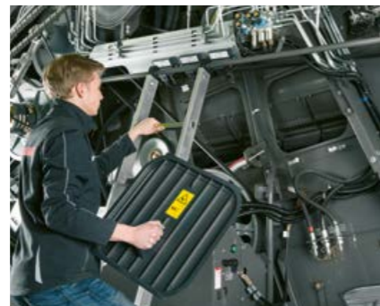
Veel bevestigingspunten voor verplaatsbare ladder.
