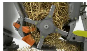
Tegenmessen en zwenkbaar bodemelement in de SPECIAL CUT hakselaar.
