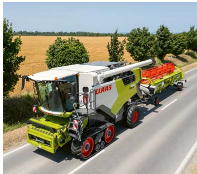
Met alle TERRA TRAC rupsbanden kan tot een snelheid van 30 km/h gereden worden. Met TERRA TRAC kan comfortabeler worden gereden dan met wielmachines.
