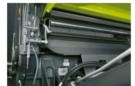
De grote stenenbak kan eenvoudig worden geopend en geleegd.
