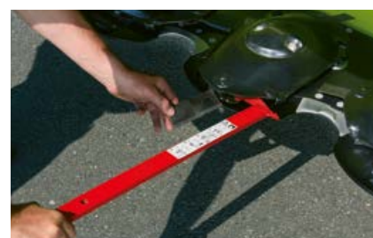
Snelwisselsysteem van de messen
