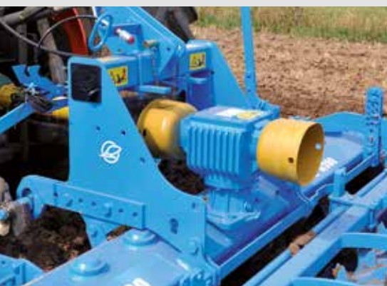
Aandrijfbak met wisselbare tandwielen
