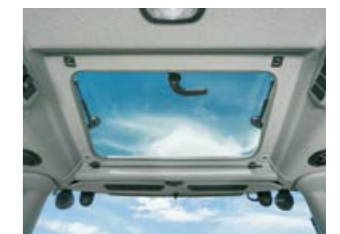
Door het glazen dakluik heeft de bestuurder altijd goed zicht op de voorlader en kan daardoor nauwkeurig en veilig werken.
