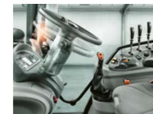
Het stuurwiel kantelt en is telescopisch in hoogte verstelbaar, zodat het perfect kan worden aangepast voor elke bestuurder.
