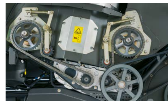
Aandrijfkast voor lossen met 180 l/s
