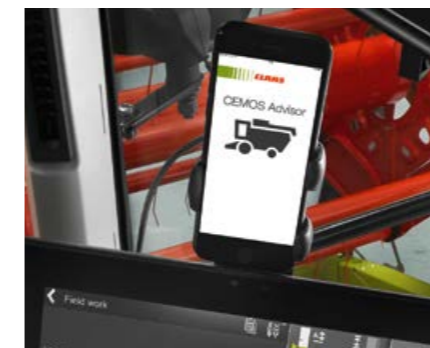
De gratis smartphone-app CEMOS Advisor is een waardevol instelhulp voor de bestuurder. De verlies-korrelberekening is al geïntegreerd.
