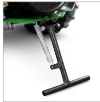
Stützfuß erleichtert das Abstellen der Maschine
