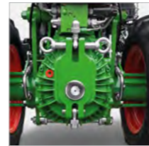
agria-Anbauflansch: einfacher und schneller Anbaugerätewechsel
