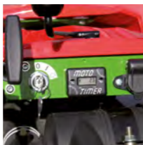
Praktische Armaturentafel inklusive Betriebsstundenzähler, Drehzahlmesser, Zündschloss und 12 V Steckdose
