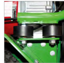
Schwingungsgedämpfter Lenkholm durch Dämpferelemente
