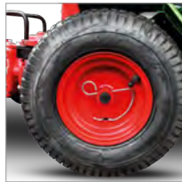
Besonders wendig durch Radfreilauf
