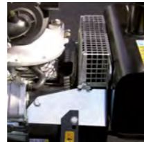
Optimierte Luftansaugung schützt den Motor vor Überhitzung
