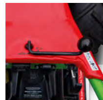
Sicheres Abstellen der Maschine mit zentraler Feststellbremse
