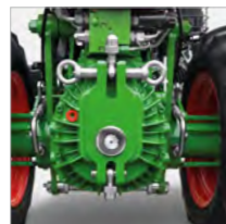
agria-Anbauflansch: einfacher und schneller Anbaugerätewechsel
