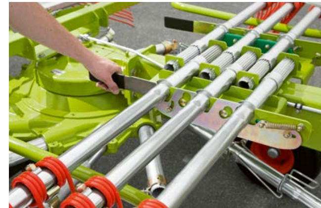
Bij enkele modellen moet voor transport tandarmen worden weggenomen. Deze kunnen snel worden opgeborgen.
