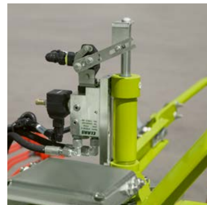
Beide zwadharken met vier rotoren zijn ook leverbaar als comfortmodel met elektrohydraulische verstelling van de harkhoogte.
