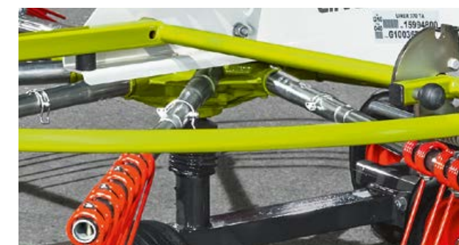
Verbinding met Citroenprofiel en klemspie bij de LINER 370 en 320.
