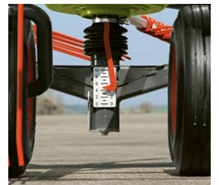
Flexibel blijven: schaalverdeling voor instellen van de harkhoogte
