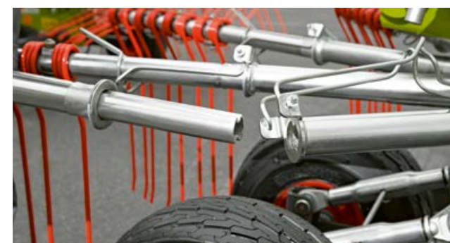
Verbinding met Citroenprofiel en PROFIX tandarm beveiliging bij de LINER 700.
