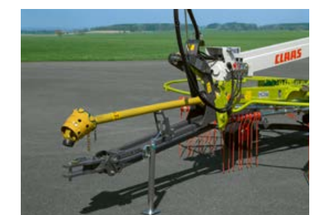
Parallelogram-dissel optioneel bij LINER 700 TWIN, standaard bij de LINER 800 TWIN.
