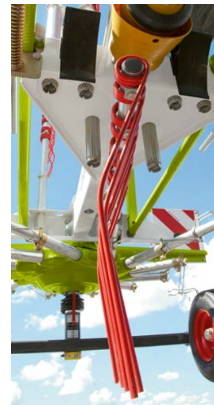
De standaard tanden bij de modellen 450, 420, 370 en 320 zijn met hun 9 mm dikte extreem stabiel en zowel geschikt voor hooi als kuilvoer.
