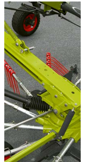
Omschakeling tussen aflegging in een of twee zwaden.
