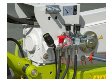
Standaard hydraulische volgorde schakeling voor tijdsinterval tussen de voorste en achterste rotor bij het opheffen en neerlaten.
