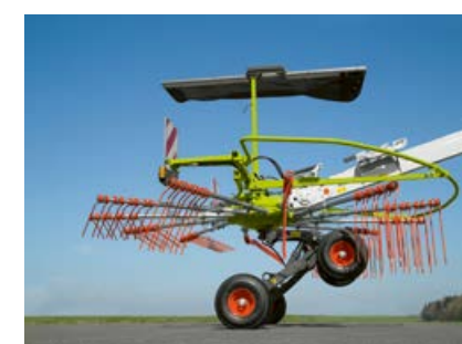
Grote hefhoogte voor het rijden over de zwaden op de wendakker: tot 50 cm bij de LINER 700 TWIN.
