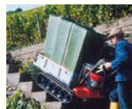
De HP 500 power carrier heeft tractie, zelfs op een helling
