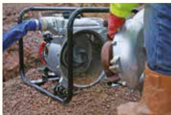
Het afneembare inspectiedeksel biedt snelle en eenvoudige toegang
