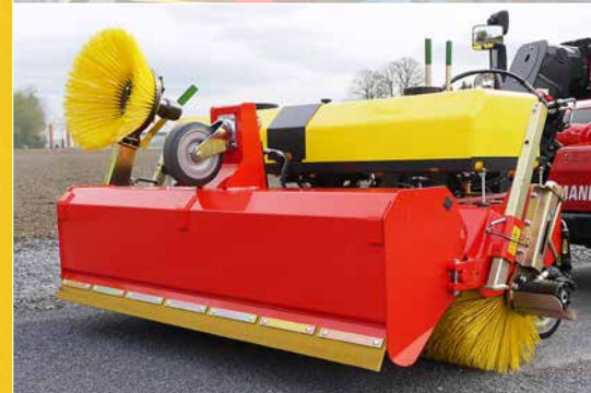
Vegen onder de bak door. Opvangbak hydraulisch kiepend met 3e steunwiel
