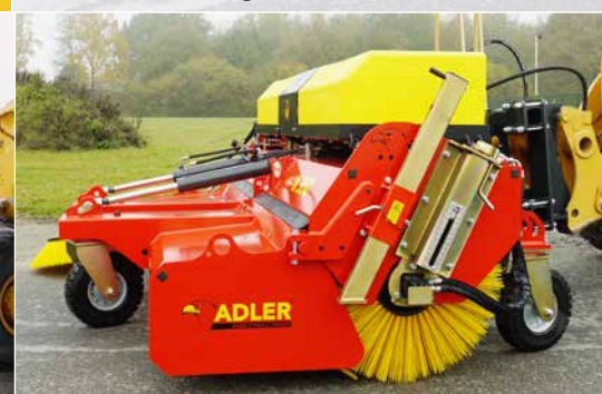
Vier grote zwenkwielen (460 x 125 mm) zorgen voor meer stabiliteit tijdens het vegen.
