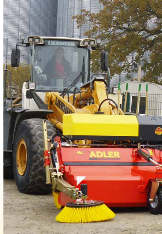
Een watersproei-installatie, dan de juiste: de zijborstel wordt altijd met een sproeidop uitgevoerd!
