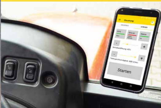
Toerental en hoeveelheid eenvoudig in te stellen vanuit de cabine met de smartphone
