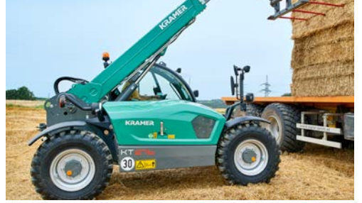
Werkhydraulica met belasting-onafhankelijke doorstroomverdeling
