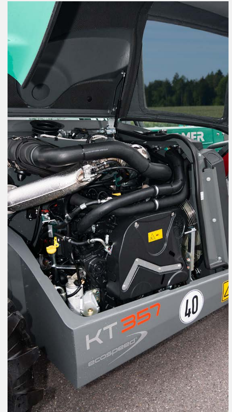
Watergekoelde 4-cilinder seriemotor met gekoelde externe uitlaatgasrecirculatie, turbolader en inlaatluchtkoeling.
