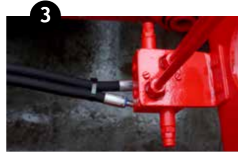
3 Hydraulisch systeem zonder accumulatoren
