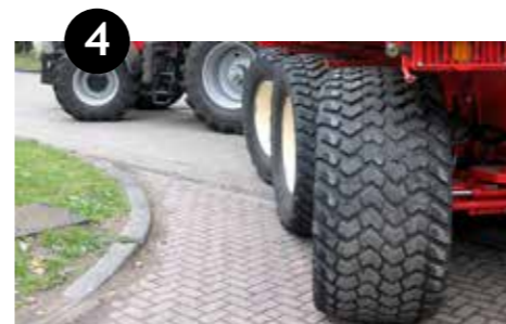
4 Grote stuurhoek, óók bij brede banden
