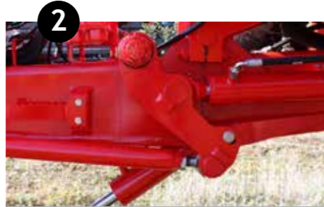
2 Spelingvrije overbrenging van stang naar cilinder
