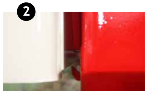
Messcherpe afsluiting van achterklep
