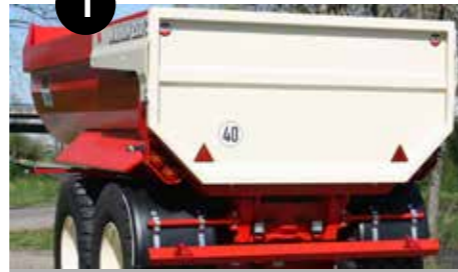
Slijtvast materiaal, 6 mm. 400HB
